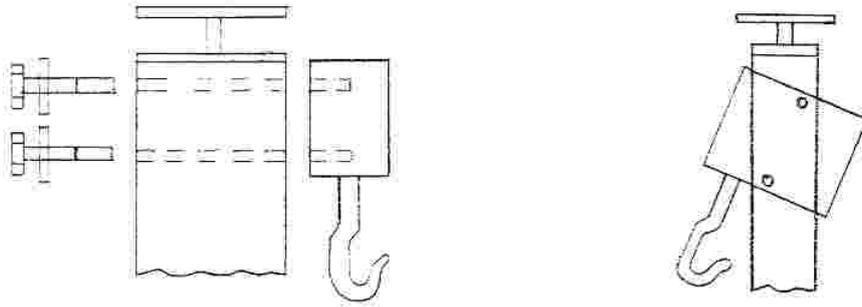
3. Setzen Sie nun die Gummiteller auf die Höhenversteller. Durch die vorgestanzten Löcher der Versteller, bohren Sie mit einem Bohrer  $\varnothing$  4 mm, jeweils 2 Löcher durch die Gummiteller.
