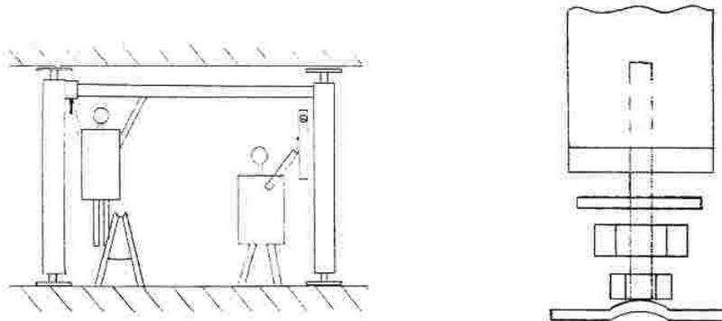
Klemmpfosten ausrichten und leicht verspannen. Reißen Sie nun durch die Löcher der Teller die 8 Befestigungspunkte der Bohrlöcher an.
